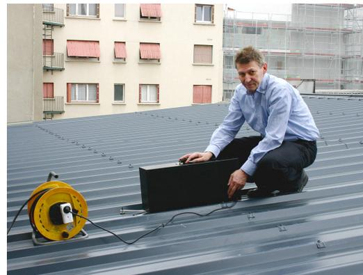
Mesurage de la transmission du bruit de la grêle sur une toiture métallique à l'aide d'une machine à chocs normalisée.
